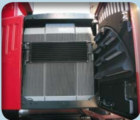
**Radiateurs** en aluminium à larges mailles avec ventilateur réversible automatique à régulation thermostatique, pour augmenter la propreté des radiateurs, réduisant la consommation de carburant. Les temps d'entrée en température du moteur et de l'huile hydraulique sont ainsi réduits et le réchauffage de la cabine est plus rapide.
