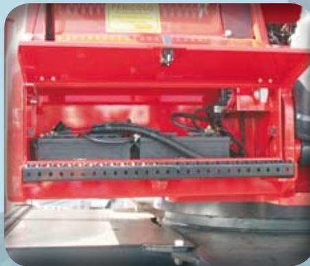
**Coffre à batteries** avec serrure pour une meilleure sécurité durant l'arrêt de la machine.
