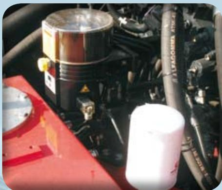
**Graissage automatique** de série pour l'équipement et la couronne d'orientation.
