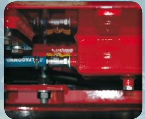
**Les robinets** de fermeture des réservoirs d'huile hydraulique et gasoil simplifient et rendent plus rapides les travaux d'entretien.
