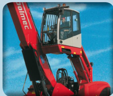
**Elévation hydraulique** à parallélogramme de série avec hauteur de vision depuis le sol à l'œil de l'opérateur de 5,2 m. Sur demande, il est possible d'atteindre une hauteur de 6,0 m.
