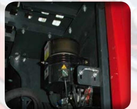
**Graissage automatique** de série pour l'équipement et la couronne d'orientation.
