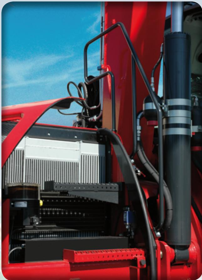
**Radiateurs** en aluminium à larges mailles avec ventilateur à régulation thermostatique et (en option) à inversion automatique, pour augmenter la propreté des radiateurs, réduisant la consommation de carburant. Les temps d'entrée en température du moteur et de l'huile hydraulique sont ainsi réduits et le réchauffage de la cabine est plus rapide.
