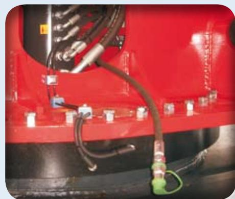
Réservoir d'huile hydraulique et réducteur de rotation avec **vidange écologique** pour rendre les opérations propres et sans risque.
