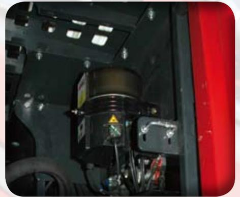
**Graissage automatique** de série pour l'équipement et la couronne d'orientation.
