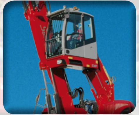
**Elévation hydraulique** à parallélogramme de série avec hauteur de vision depuis le sol à l'œil de l'opérateur de 5,2 m. Sur demande, il est possible d'atteindre une hauteur de 6,0 m.
