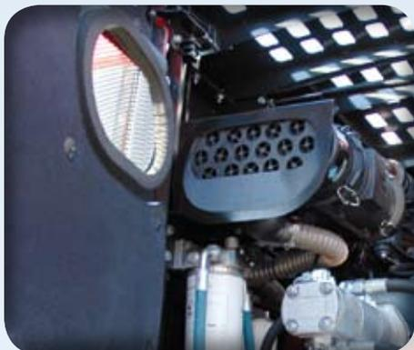
**Filtre à air à micros-cyclones** avec système autonettoyant à dépression de série : temps et coûts d'entretien diminués, meilleure efficacité du filtre à air, condition de travail optimale pour le moteur diesel.
