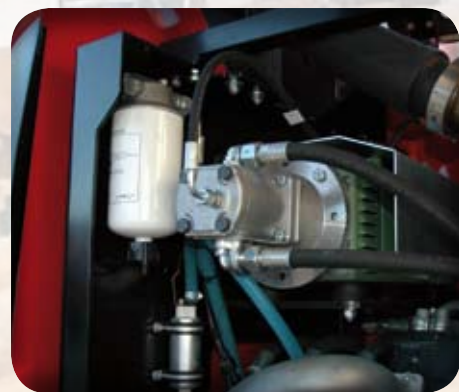
Génératrice pour électro-aimant, entraînée par un moteur hydraulique et montée sur silent-blocs. (en option)
