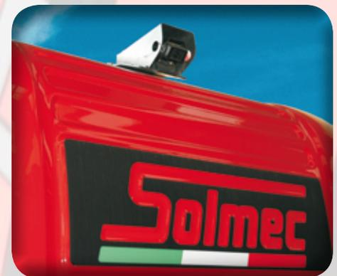
**Caméra arrière** avec écran couleur de 7 pouces en cabine (Possibilité d'installation sur flèche).
